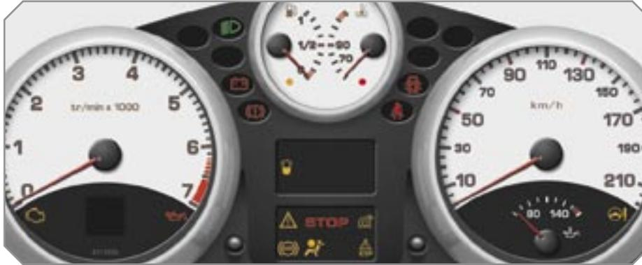
Moteur tournant ou véhicule roulant, l'allumage de l'un des témoins suivants indique l'apparition d'un défaut nécessitant l'intervention du conducteur.
