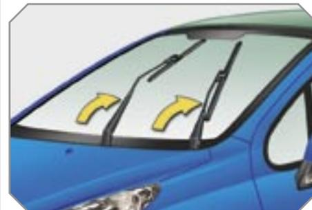
Dans la minute qui suit la coupure du contact, toute action sur la commande d'essuie-vitre positionne les balais en milieu de pare-brise.
