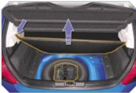
Les outillages sont installés dans le coffre sous le plancher.
