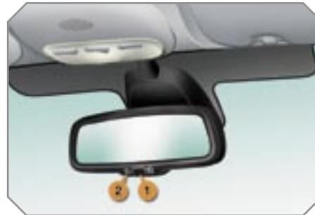
Afin d'éviter l'éblouissement, le miroir du rétroviseur intérieur s'assombrit automatiquement en fonction de l'intensité lumineuse provenant de l'arrière.
