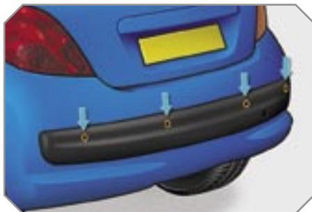
Il détecte tout obstacle (personne, véhicule, arbre, barrière,...) situé derrière le véhicule, mais il ne pourra pas détecter les obstacles situés juste sous le pare-chocs.
