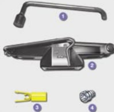
1. Clé démonte-roue. Permet la dépose de l'enjoliveur et la dépose des vis de fixation de la roue.
