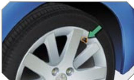
Des capteurs, montés dans chaque valve, déclenchent une alerte en cas de dysfonctionnement (vitesse supérieure à 20 km/h).
